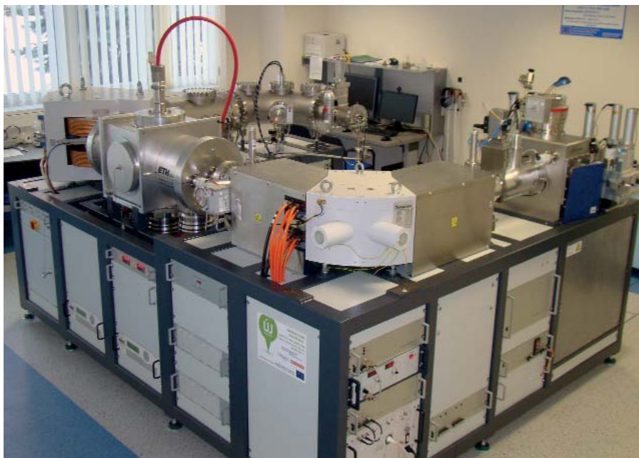
Gyorsító tömegspektrométer radiokarbon-méréshez (MTA Atomki Hertelendi Ede Környezetanalitikai Laboratórium)
