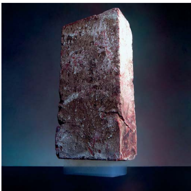
3. ábra. Építési (2,5 kg-os) téglát megtartó 0,2 g-nyi aerogél [7]
