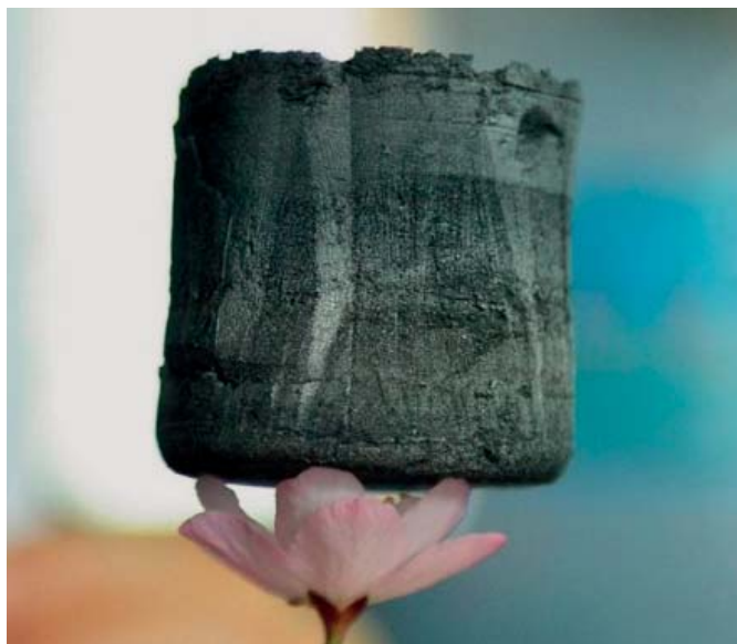
5. ábra. Szénnanocső-grafén LUK aerogélek törékeny növényi „alátéteken” [16,17,18]
