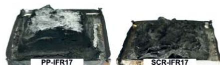
4. ábra. 17% IFR-t tartalmazó egyszerű PP keverék és önerősített kompozit égési maradékai
