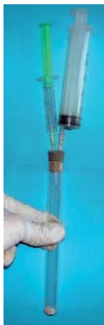
2. ábra. Acetilén előállítás kalcium- karbid és víz reakciójával
