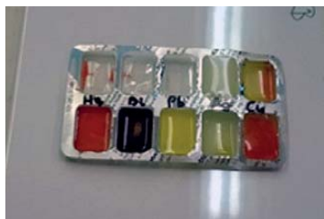
3. ábra. A tablettatartó mint reakciótér
