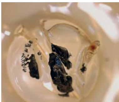
6. ábra. Ezüstkiválás akrilgyöngyben (ezüst-nitrát-oldat elektrolízise)
