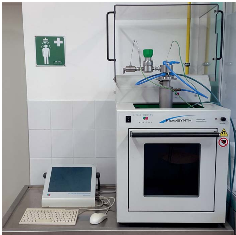
A csoport másik folytonos mikrohullámú reaktora. Fölül a hűtő látszik. Alatta teflonszőben játszódik le a reakció. „Ezt magunk alakítottuk át a megfelelő kapacitásra”
