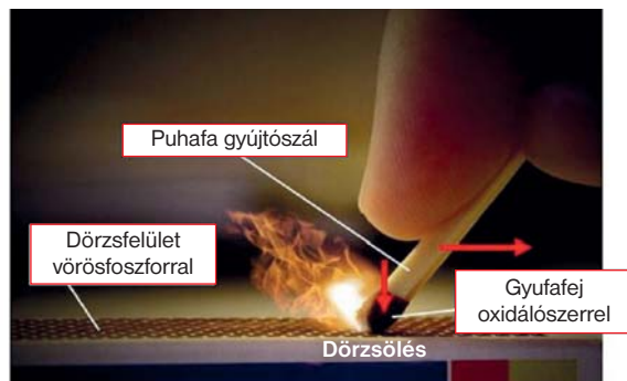
A dörzsölés hatására a gőzzé alakult vörösfoszfor gyűjtja be az oxidálószerrel a gyufafejben → az égés átterjed a gyújtószálra
