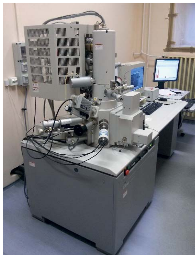
1. ábra. Az Intézet energiadiszipatív röntgenanalizátorral összeépített pásztázó elektronmikroszkópja
