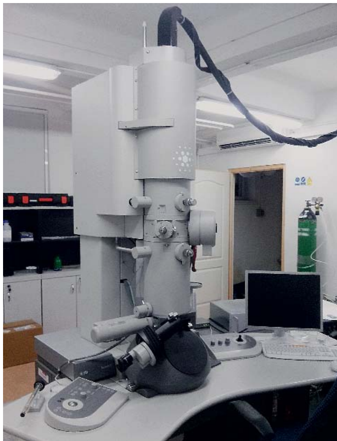
2. ábra. Az Intézet nagy felbontású transzmissziós elektronmikroszkópja
