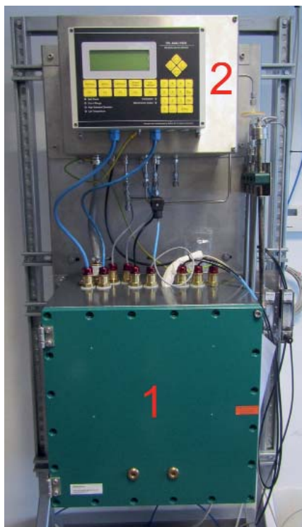
2. ábra. Fotoakusztikus kén-hidrogén-mérő fényképe. 1. A nyomás-állító tokozás, amelyben az elektronika és a lézerek találhatók, 2. a fotoakusztikus kamrákat tartalmazó rozsdamentes doboz
