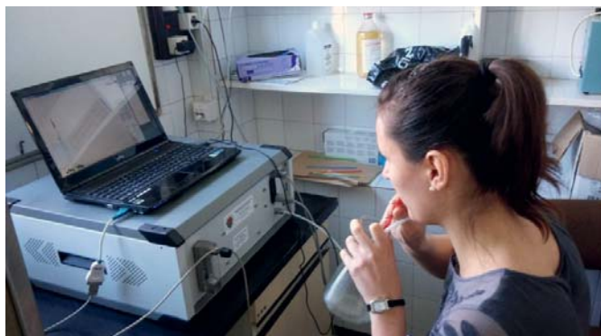
3. ábra. Kilélegzett levegő metánkoncentrációjának mérése fotoakusztikus műszerrel. Az alany egy csövön keresztül fújja egy üvegpalackba a kilélegzett levegőt, amelyet a műszer folyamatos gázáramlás mellett mintavételez
