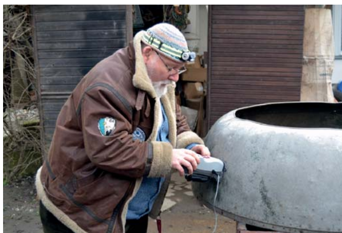
4. ábra. Spektrofotométeres vizsgálat egy MÁVAG-Héja vadászgyakorlógép NACA motorgyűrűjén
