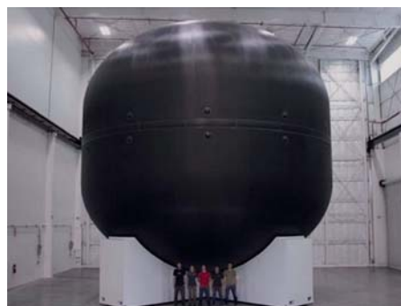
10. ábra. Gigantikus szénszálás és grafittal kombinált gömb, űrhajó tüzelőanyagának tárolására
