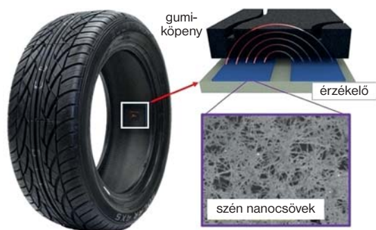
9. ábra. Grafénerősítéssel és -érzékelővel ellátott gumiabroncs
