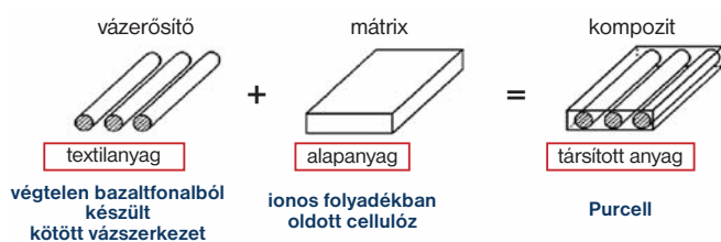
1. ábra. A Purcell-kompozit felépítése
