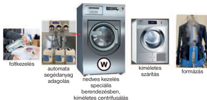
7. ábra. A nedves tisztítás folyamata
