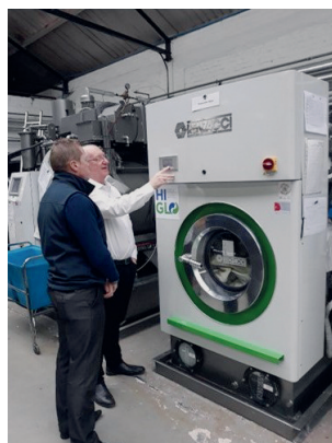
8. ábra. A perklor-etilén kiváltása a vegytisztításnál egyedi oldószerkeverékkel és speciális berendezéssel
