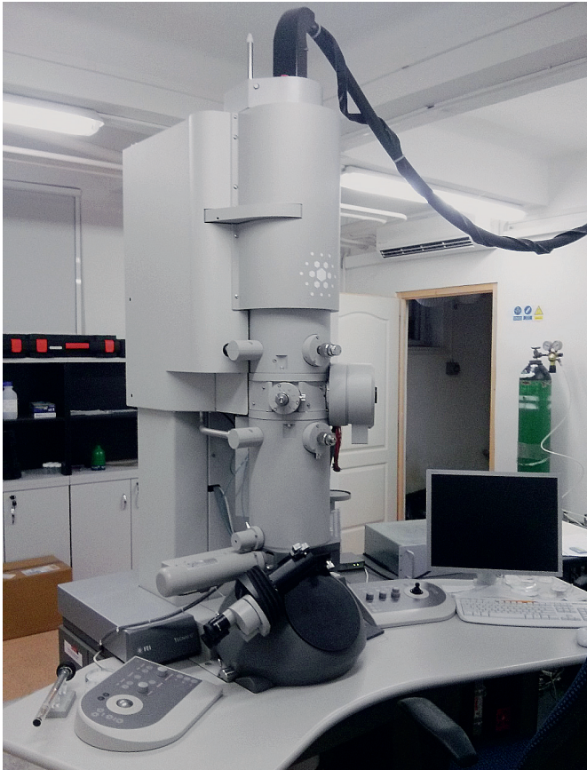
2. ábra. Az Intézet nagy felbontású transzmissziós elektronmikroszkópja
