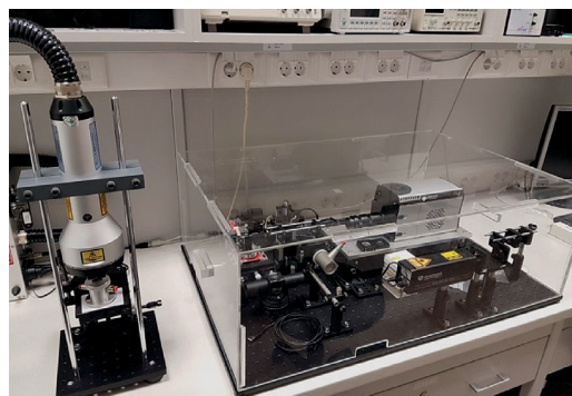
3. ábra. Kompakt térbeli heterodin LIBS spektrométer-elrendezés a kutatócsoport laborjában. Bal oldalon: a lézerindukált mikroplazma keltésére szolgáló lézernyalábforrás és a mintát befoglaló, zárt ablációs kamra, mely utóbbit szükség esetén szabályozott gázatmoszférával lehet ellátni. Jobb oldalon: az interferometrikus kísérleti elrendezés nagy sebességű kamerával és motorosan mozgatott optikai elemekkel, pormentes környezetben. A rendszer két része között a fényvezetést száloptika biztosítja, ez a képen nem látható
