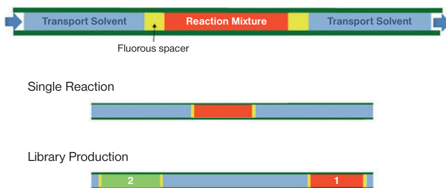
7. ábra. A fluoros oldószerrel szétválasztott folyadékáramok (cseppek) lehetőséget nyújtanak gyors egymást követő reakcióra és könyvtárszintézisre
